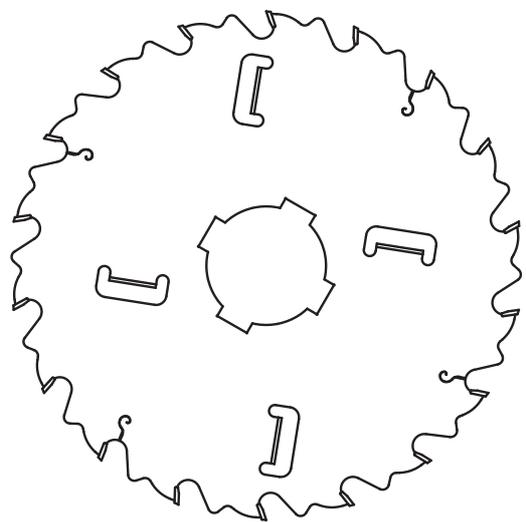
Пилы из группы **PI-502** – это пилы с ограничителем подачи, с прямым зубом GM, с двумя открытыми (+2) либо с двумя открытыми и двумя закрытыми (+4) боковыми зубьями, предназначены для работы на многопильных станках, для продольной резки сухой мягкой или твердой монолитной древесины. Пилы покрыты специальным материалом, который предохраняет тело пилы от налипания живичных смол и уменьшает силы трения.
