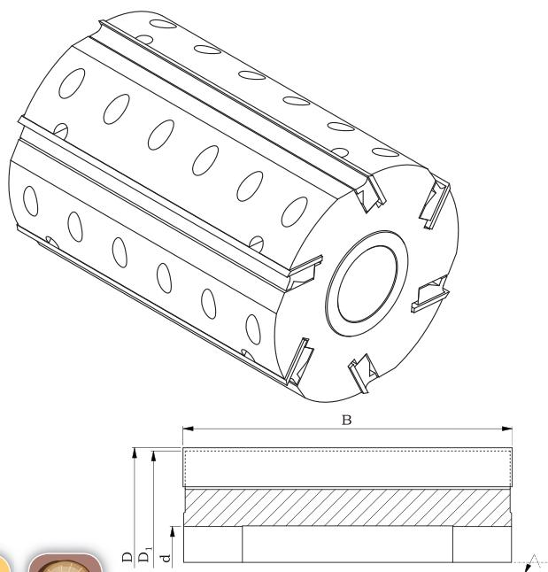
Фрезерная головка 1100-4 – это насадная прямая головка со сменными ножами с соответствующим количеством зубьев предназначена для профессиональной обработки древесины. Головка служит для обработки плоских поверхностей. Регулировка высоты режущих ножей осуществляется с помощью пружин. Головка приспособлена для снятия неровностей в материале высотой до 5 мм для черновой обработки и 0,8 мм для чистовой обработки. Корпус головки может быть как стальной, так и алюминиевый.
